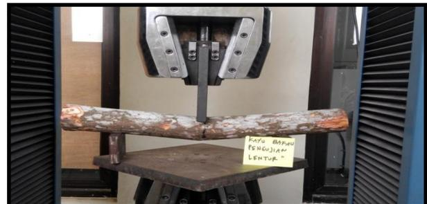
**Gambar 4. 3.** Bakau saat pengujian lentur
