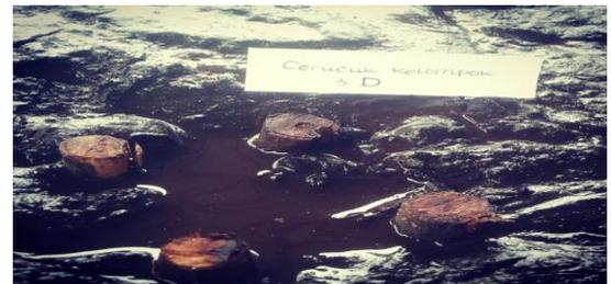
Gambar 4.9. Cerucuk Bakau Grup Spasi 3 d bakau group dengan variasi spasi 3 d pada penurunan 20 mm sebesar 11,1 kg.
