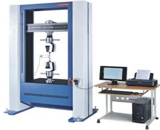
Gambar 3.8. Alat Uji tarik HUNG TA HT-8503
