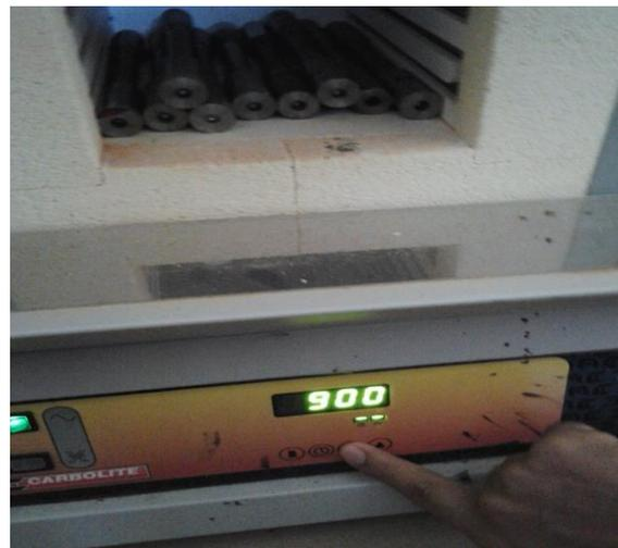
Gambar 3.4. Spesimen dipanaskan 930°C dalam oven
