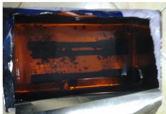
Gambar 3.5.. Pendinginan specimen menggunakan Oli SAE 40
