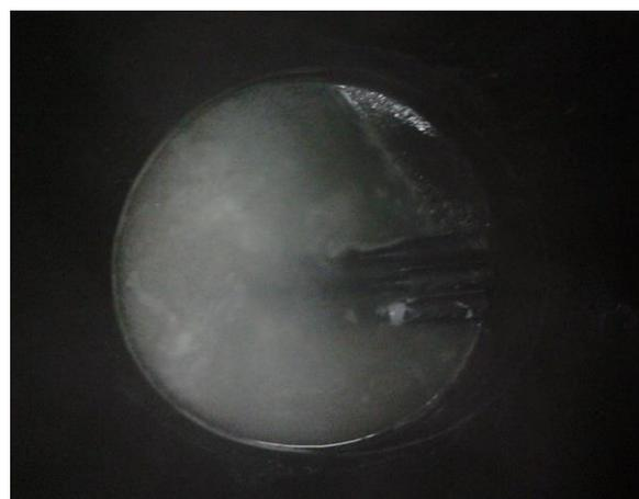
Gambar 3.6.. Pendinginan specimen menggunakan larutan garam
