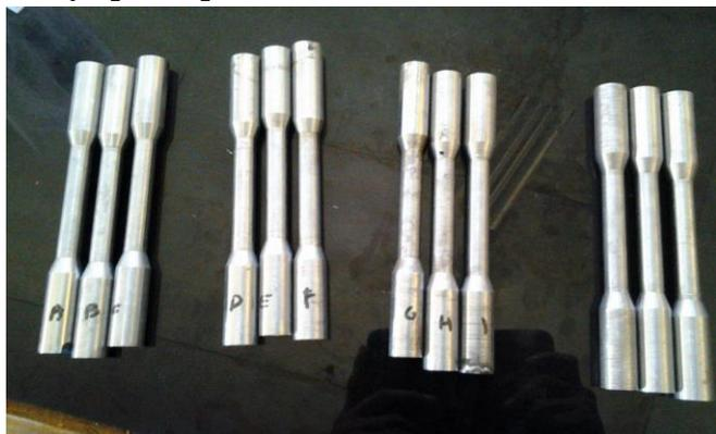
Gambar 3.3. Spesimen Uji Tarik Baja Karbon AISI 1040
