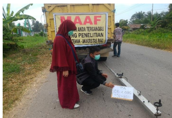
Gambar 3.1. Cara kerja alat Benkelman beam
