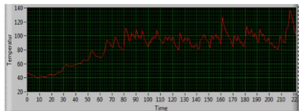
Grafik 2. Temperatur udara masuk reaktor pada 100°C
