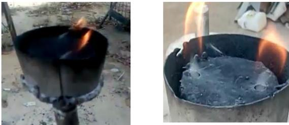
Gambar 6. Syngas yang berupa asap dapat terbakar pada keluaran alat uji updraft gasifier
