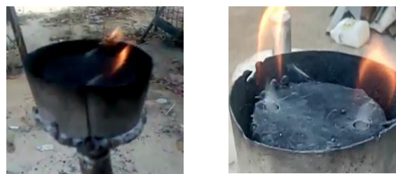
Gambar 6. Syngas yang berupa asap dapat terbakar pada keluaran alat uji updraft gasifier
