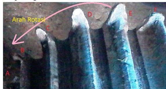
Gambar 1. Permukaan patah pada spur gear
