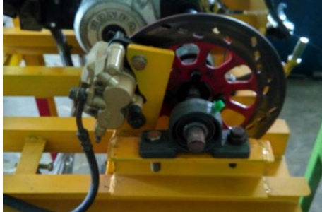
Gambar 15. Pembebanan rem cakram
