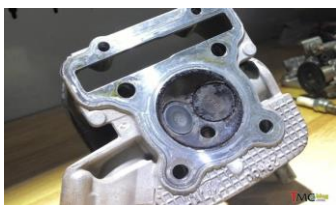
Gambar 10. Katup masuk dan katup buang pada kepala silinder
