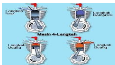
Gambar 4 siklus kerja empat langkah
