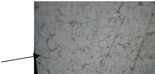
Gambar 5.7 Bentuk struktur mikro baja SCM 440 kondisi double hardening I 900 °C pembesaran 100x
