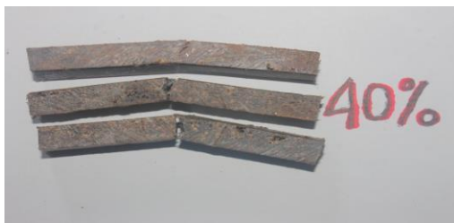
Gambar.8 Sampel uji bending fraksi 40% serbuk + 60% matriks
