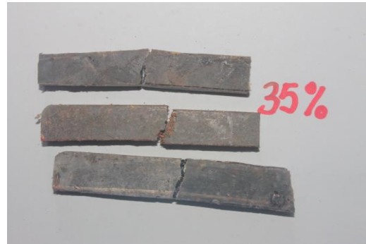
Gambar 3 Sampel uji impact fraksi 35% serbuk + 65% matriks
