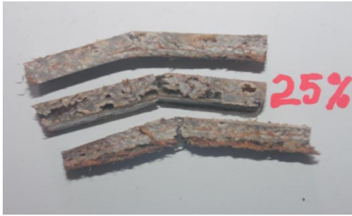
Gambar .5 Sampel uji bending fraksi 40% serbuk, 60% matriks Fraksi vol 30% serbuk partikel serat kayu akasia, 70% matriks, temperatur 175 0 C, waktu penahanan 45 menit. Dari hasil pengujian didapat data sebagai berikut:
