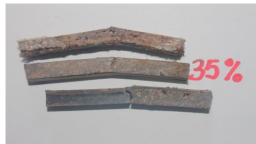
Gambar 7 Sampel uji bending fraksi 40% serbuk 60% matriks
