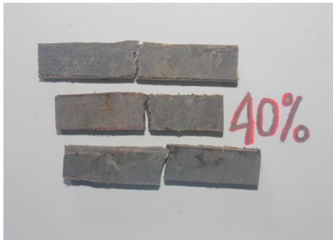
Gambar 4. Sampel uji impact fraksi 40% serbuk + 60% matriks
