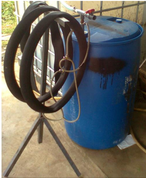
Gambar 4. Penampung biogas (Gambar penampung gas dari drum plastik, 2015)
