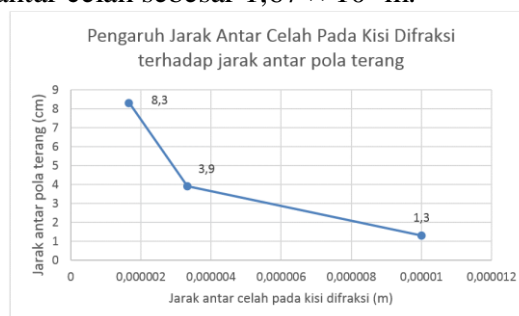
Gambar 9. Grafik Pengaruh Jarak antar celah pada Kisi difraksi terhadap jarak antar pola terang
