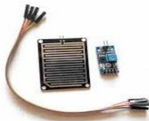
Gambar 3. Sensor Air (Detektor Air)
